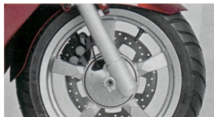
In der runden Dose rotiert der Sensorkranz des ABS
